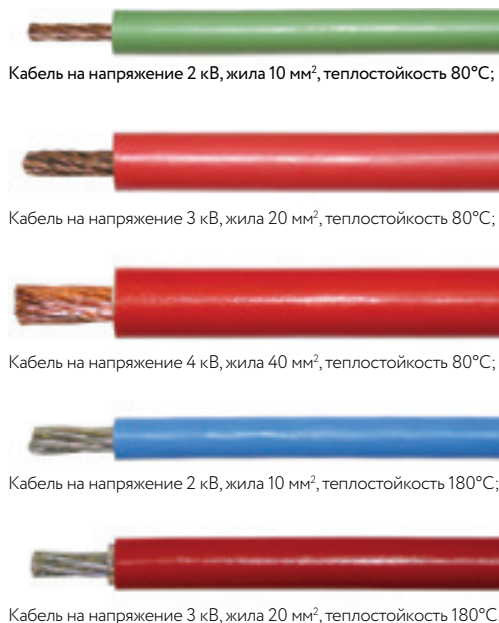
Рис. 1. Внешний вид высоковольтных кабелей, используемых в скин-системах обогрева.
