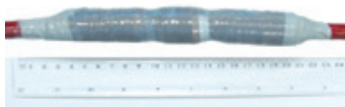
Рис. 3. Внешний вид собранного соединителя ИРС-Л; предельная температура 180°C.
